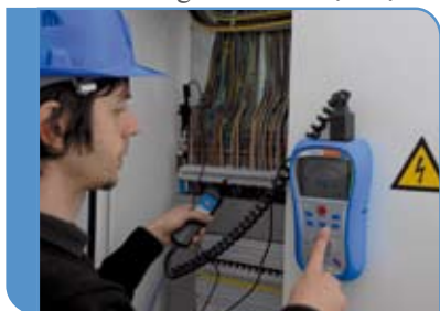
Gắn thiết bị lên vật liệu nhiễm từ giúp kiểm tra thuận tiện hơn
